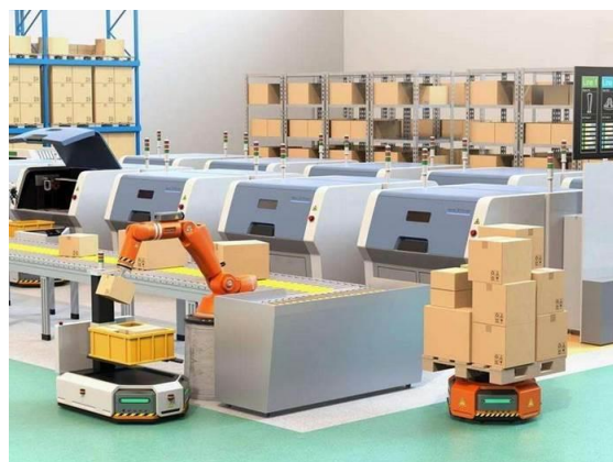
图 3：自动导引车（AGV）
