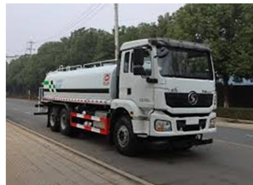
图 5：多功能抑尘车可以有效降低原料运输过程中灰尘产生的空气污染
