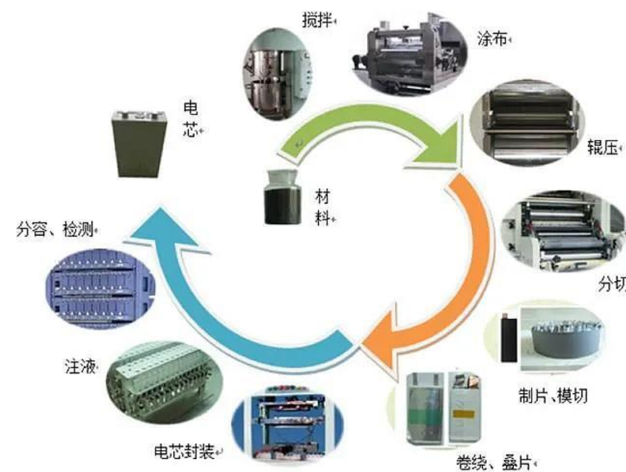
图 12：锂电池生产制造流程
