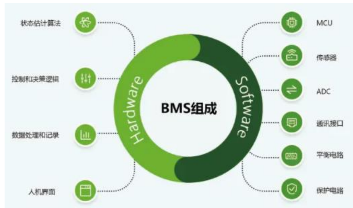
图 13：BMS 电池管理系统的组成
