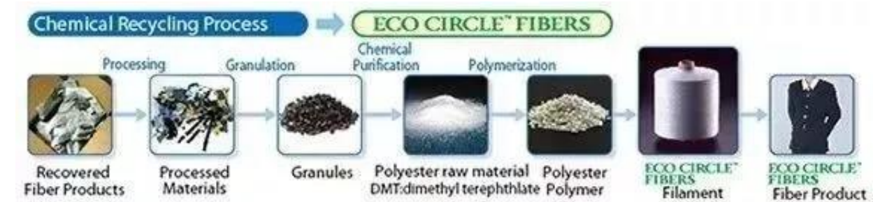
图 17：化学法循环利用的流程
