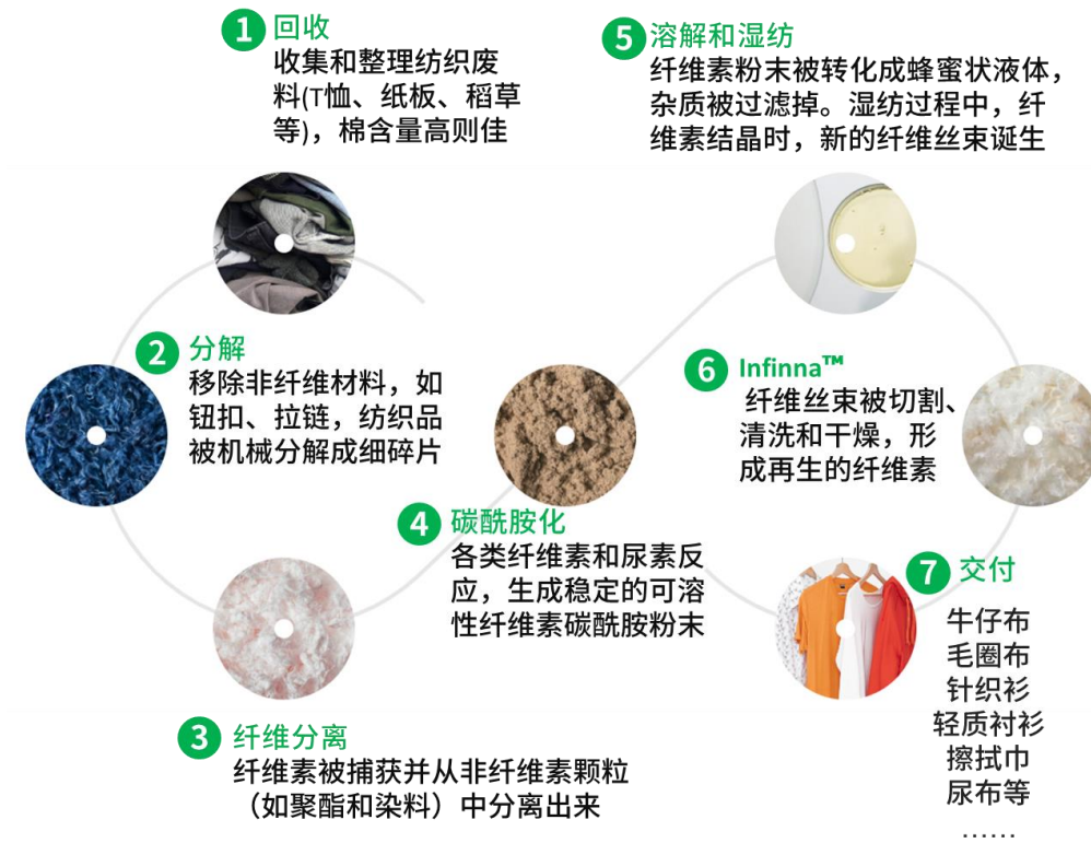
图 18: Infinited Fiber Company 的循环再利用流程
