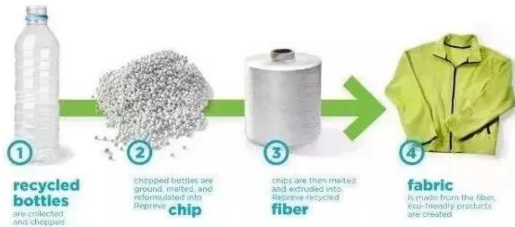
图 16：物理法循环利用的流程
